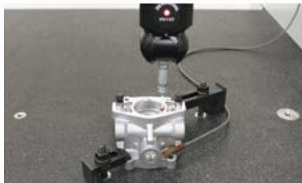
基準穴からのねじ穴距離や位置度の測定(三次元測定) For measuring threaded hole position and distance from the datum (using CMM)
