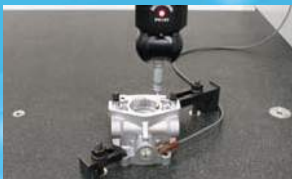
基準穴からのねじ穴距離や位置度の測定（三次元測定）
