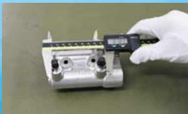
複数のねじ穴ピッチ距離の測定（ノギス測定）
