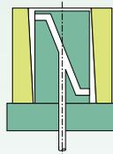
内径と端面の直角度測定
