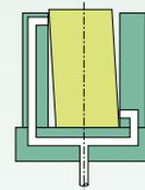
外径と端面の直角度測定
